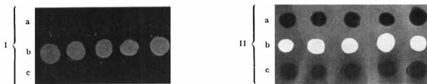
Fig. 6. Aufhebung der photographischen Reaktion von Cystein durch Zusatz von Natronlauge oder Silbernitratlösung. Einfluss eines vorzeitigen Unterbruchs der Entwicklung
